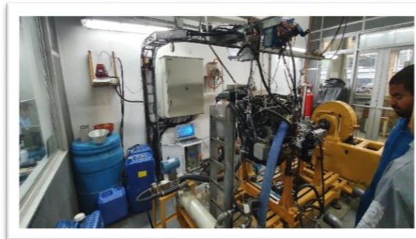
Pruebas en motor a diesel real, mezclas con diesel convencional – GIMEL UdeA
