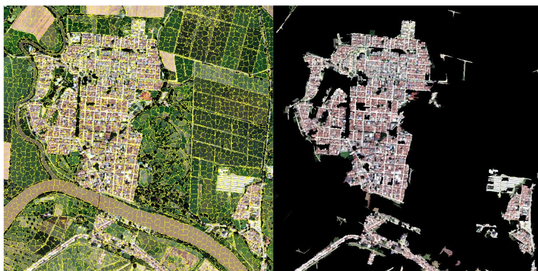
Figura 11. Resultados de clasificación de la metodología 2. A la izquierda la imagen satelital con los superpíxeles encontrados, a la derecha los superpíxeles que se clasificaron como construcción.
