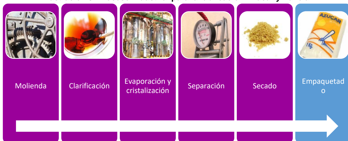
Ilustración 3. Proceso industrial para la fabricación Azúcar y Panela
